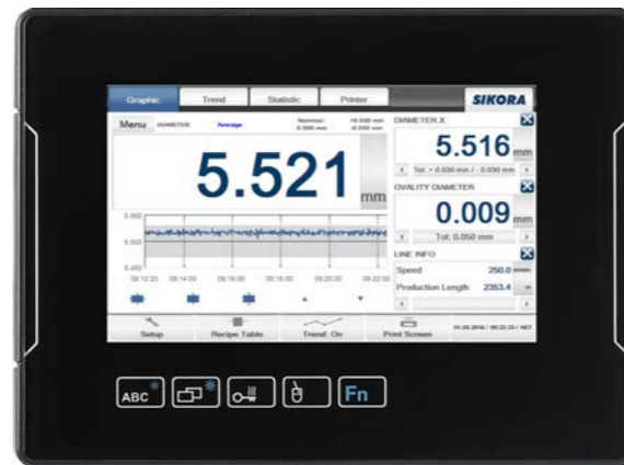
Auf dem ECOCONTROL 600 werden die Messwerte der LASER Series 6000 Meßköpfe in Echtzeit visualisiert
